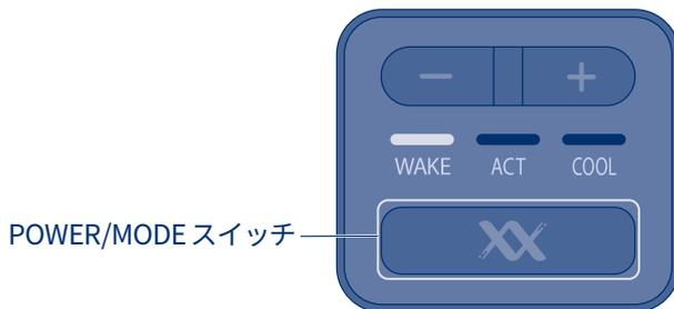
POWER/MODEスイッチを押すごとに、以下の順番でモードLEDが点滅します。
